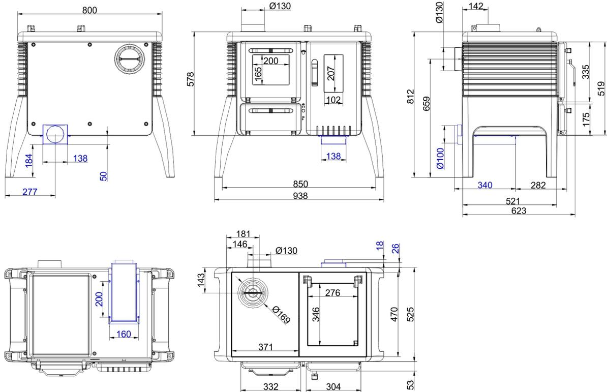
... mit Anschluss für Verbrennungsluft
