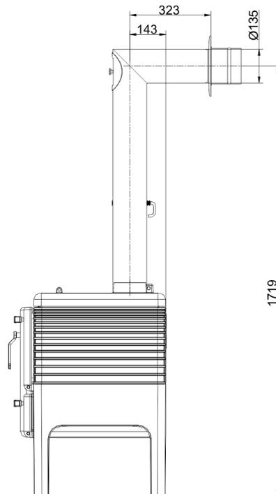
... mit Abgasrohr-Anschlusset horizontal und L
